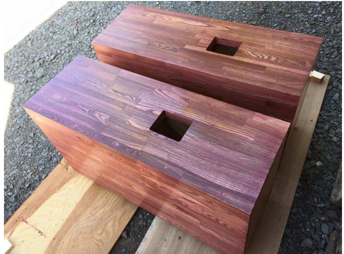
■ 下地塗装 (BOX 部)
