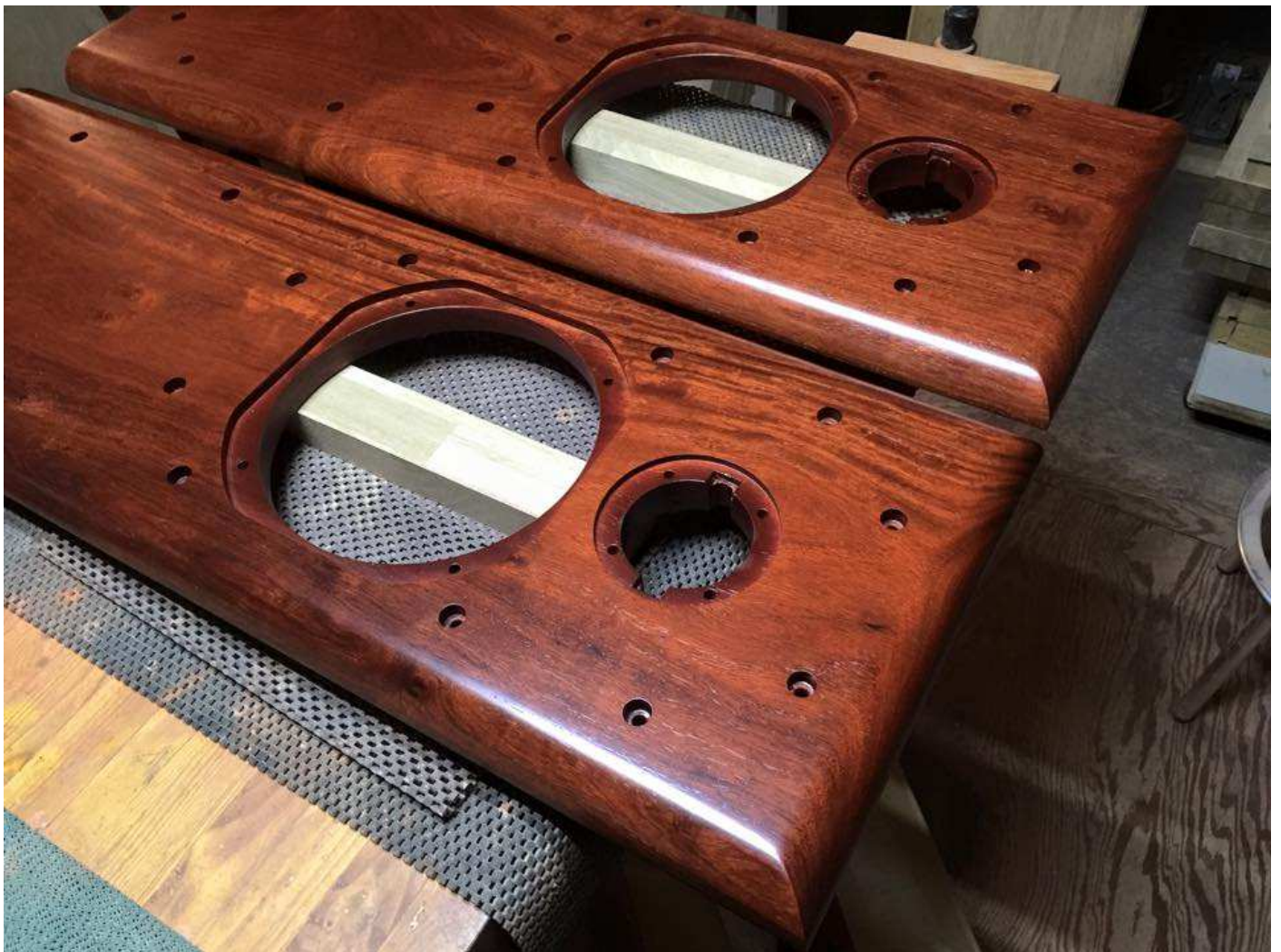
■ 完成間近のバッフル板
