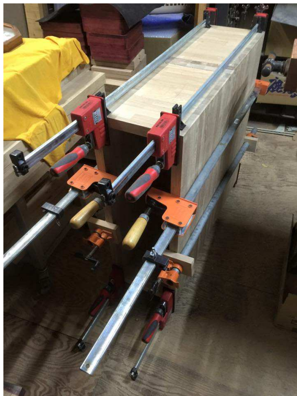
■ 23日～ BOX部の組み立て
