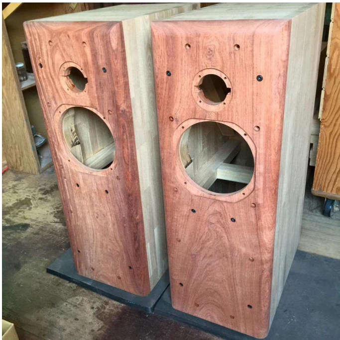
■ 塗装前の加工が完了した BOX
