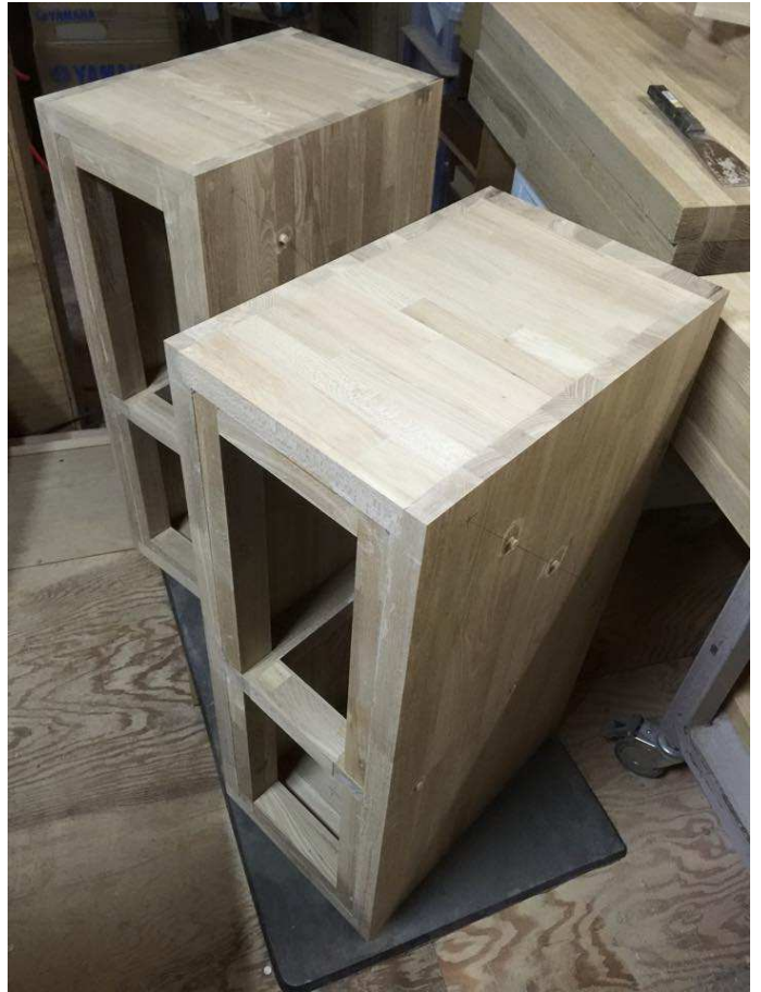
■ バッフル用棧と補強材の取付
