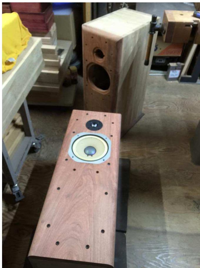
■ ユニットの取付確認
